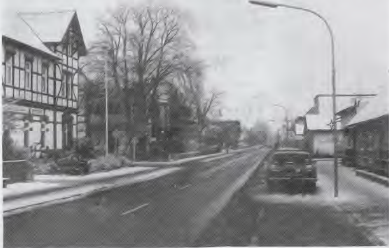
Hauptgefahrenpunkt Kieler Straße. Der Parkstreifen behindert die Sicht. Fahrzeugführer können sich nicht auf ein nicht verkehrsgerechtes Verhalten von Fußgängern (insbesondere) Kindern, Hilfsbedürftigen und älteren Menschen) einstellen. Außerdem: Die Optik verführt zum schnellen Fahren.
